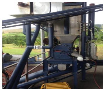
ドライミル（天日+乾燥機）→スクリーン選別→比重選別
