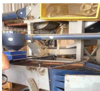
ドライミル（天日+乾燥機）→スクリーン選別→比重選別
