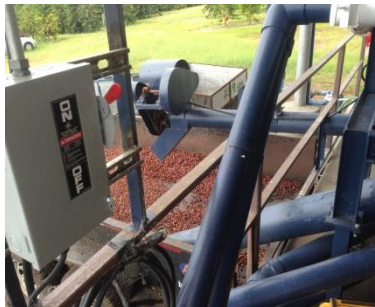
ドライミル（天日+乾燥機）→スクリーン選別→比重選別
