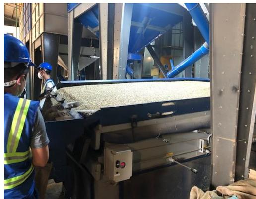
パーチメントの乾燥にはハスクと呼ばれる脱殻したパーチメントを燃料として使用し、その際に出る排気は水蒸気のフィルターを通して綺麗な空気に戻して排出しています。
