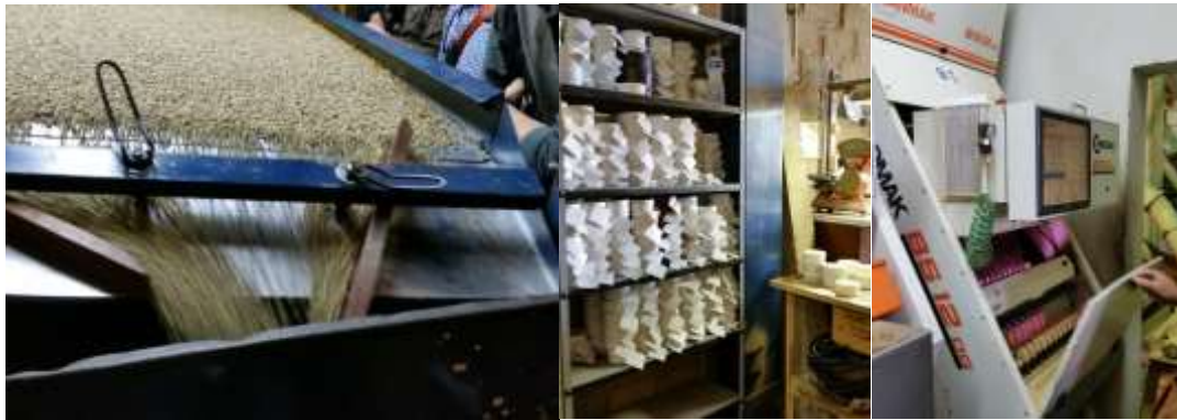
↑エスポカセル内の比重選別機、生豆サンプル室、カラー選別機。
